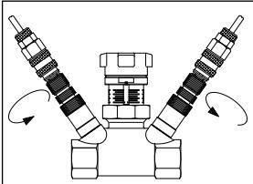
5. Zur Differenzdruckmessung Messnadelabsperrung öffnen.
